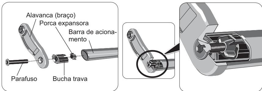
3.2 - Montar acabamento nas duas bases.
