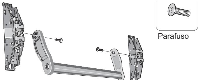
3.4) Fixar as duas bases do conjunto montado (barra, alavancas (braços) e bases), na porta. Usar 4 parafusos por base.
